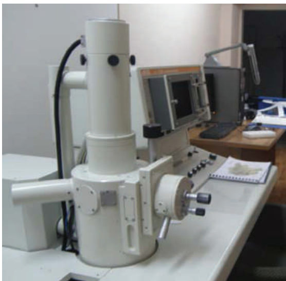
Сл. 3. Скенирачки електронски микроскоп (SEM) на Институтот за физика на Природно-математичкиот факултет во Скопје. Дава зголемување до 200 000 пати.
