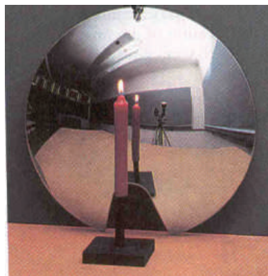
Сл. 7. Оптичка шема и фотографија за добивање на лик на предмет со испакнато сферно огледало.
